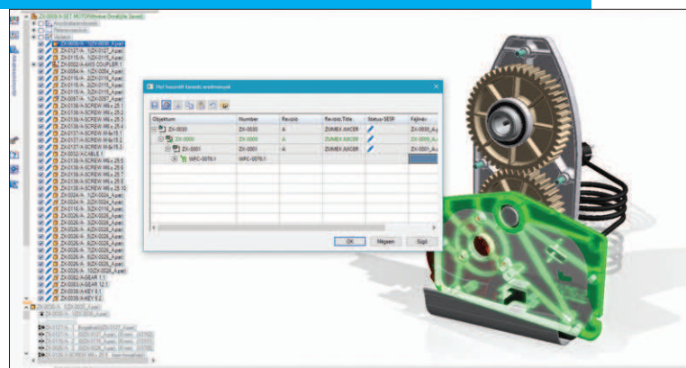
3. ábra: A „Hol használt” keresés megtalálja, hogy az adott alkatrész melyik szerelésbe van beépítve
